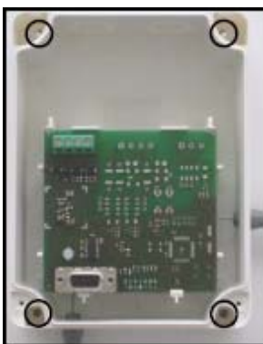
Fig. 5 – Fori per l'inserimento delle viti di fissaggio a parete
