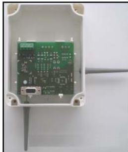
Fig. 2 – Vista interna del modulo espansore
